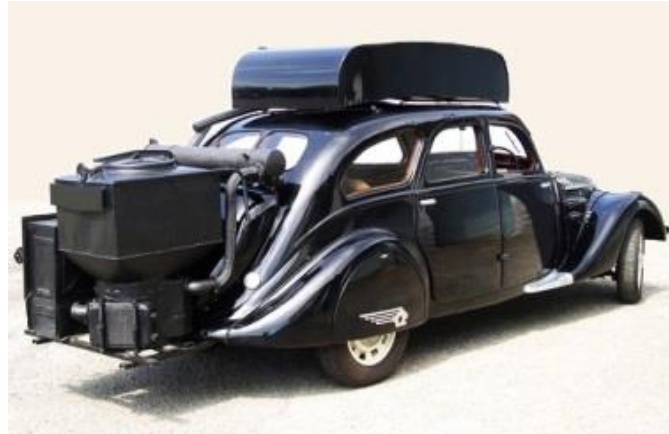
Une 402 Peugeot équipée d'un gazogène.
