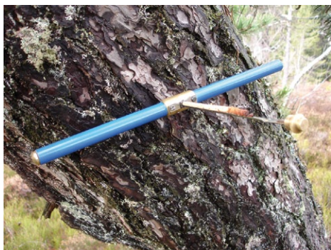
Figure 2 : Photographie montrant le carottage d'un pin sylvestre à la tarière manuel And Matson (photo Hervé Cubizolle)
