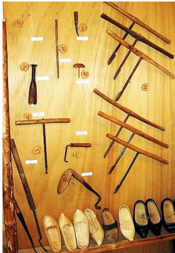
Chèvre de démonstration de Guy Sahuc, sabotier au Brignon (Solignac. Haute-Loire) lors des fêtes de La Neira. On distingue la lame du paroir à droite, les tarières en T, et des gouges, à gauche.
