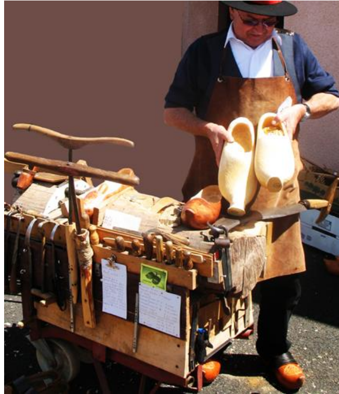
Chèvre de démonstration de Guy Sahuc, sabotier au Brignon (Solignac. Haute-Loire) lors des fêtes de La Neira. On distingue la lame du paroir à droite, les tarières en T, et des gouges, à gauche.
